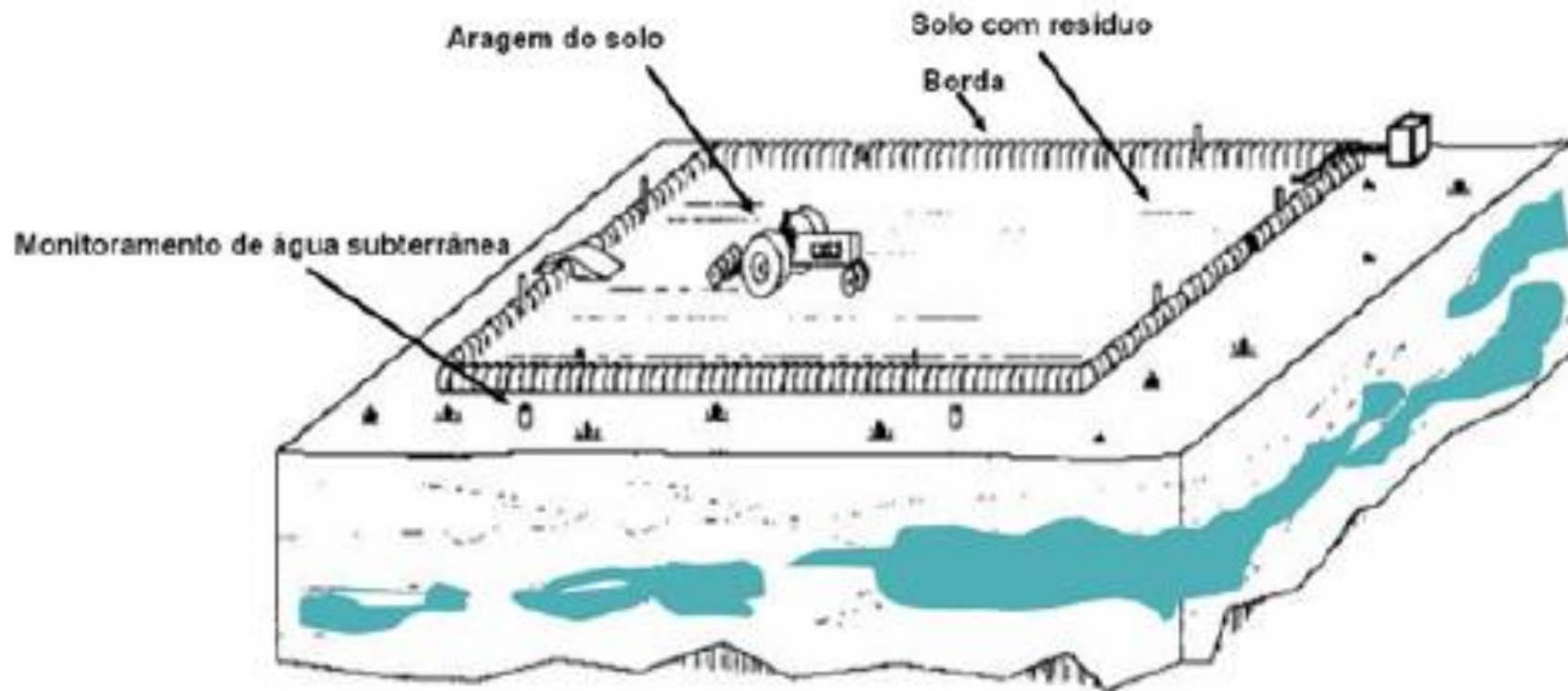
Figura 2.3: Sistema de Landfarming – Perspectiva superior Fonte: Adaptado de MPHEKGO & CLOETE, 2004
