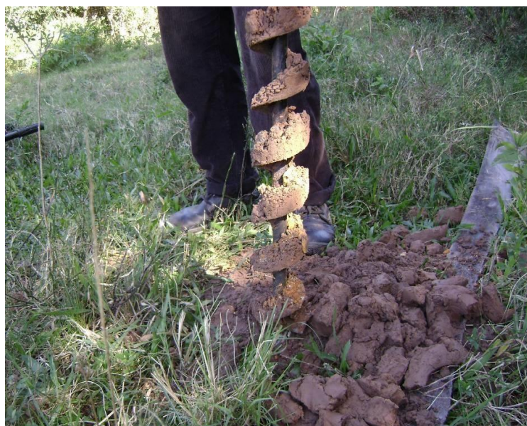
Figura 5. Sondagem ST-01: na parte final da broca perfuratriz, observa-se o saprolito, em tons alaranjados, que impediu o avanço da sondagem.
