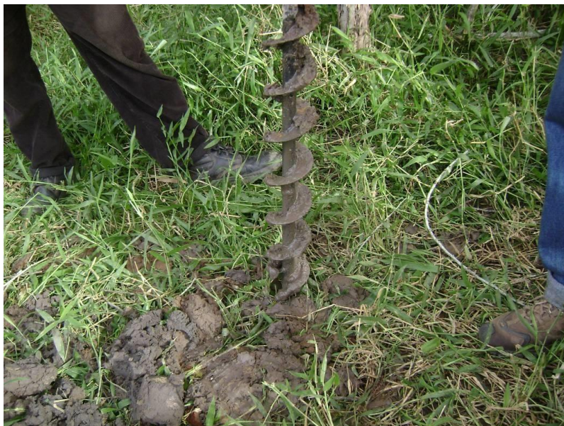
Figura 6. Sondagem ST-04, onde observa-se a coloração acinzentada dos intervalos junto ao lençol freático.
