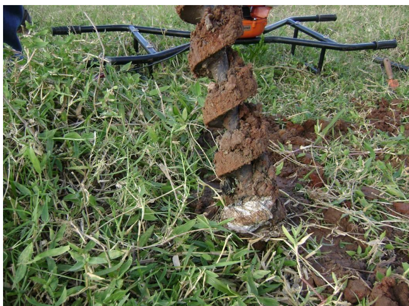
Figura 7 Nas duas sondagens realizadas no topo do local do antigo aterro, que foi recoberto por solo; posteriormente houve o plantio de gramíneas; foi observada a presença de diversos plásticos.
