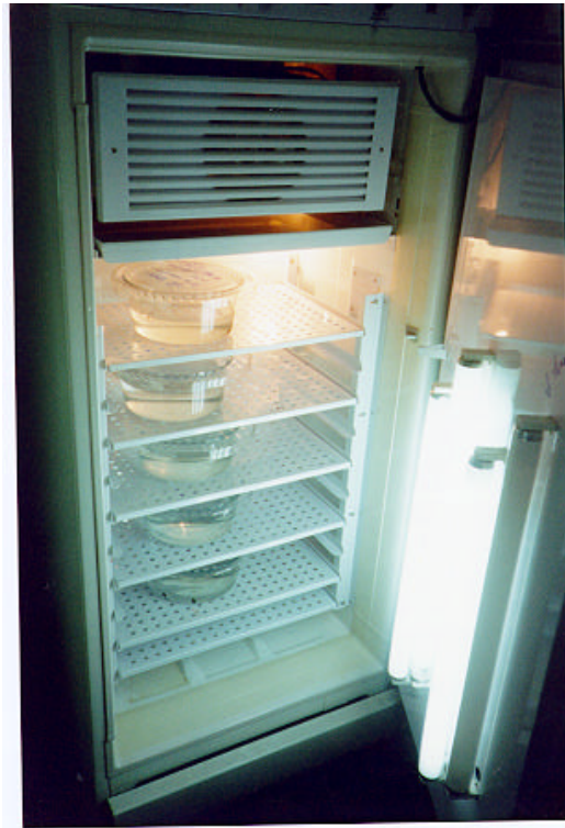
Figura 7. Câmara de germinação com temperatura e fotoperíodo controláveis.
